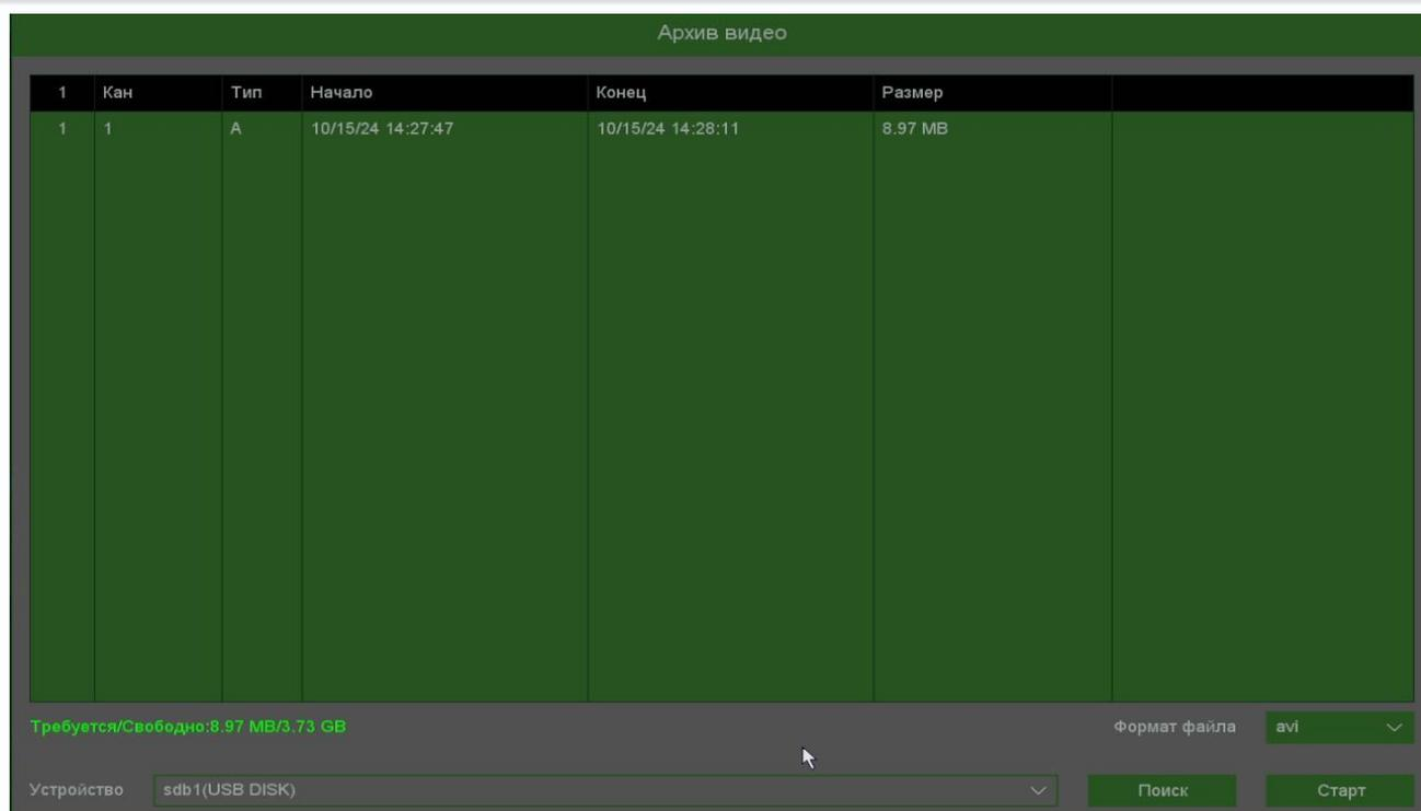
**Формат файла** – формат экспортируемого файла – **dav** (записи могут быть многоканальными, проигрываются специальным плеером **vPlayer** из комплекта поставки регистратора) или **avi** – одноканальные записи.
