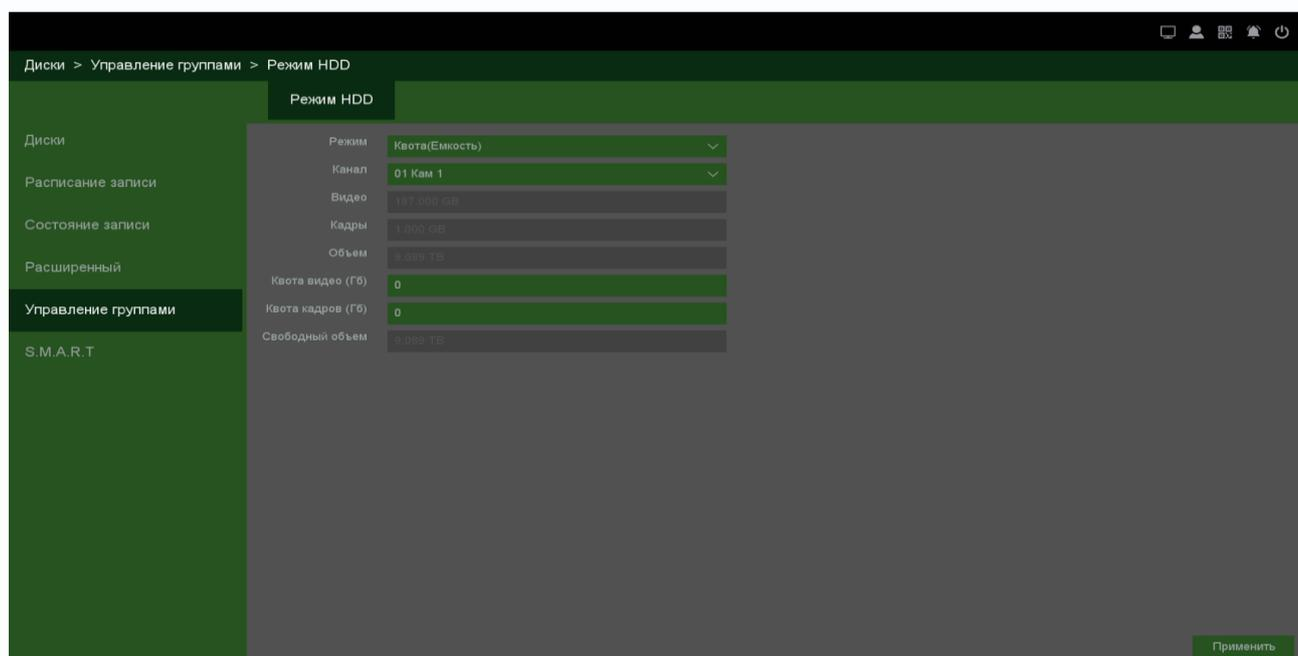
В этом режиме для камер можно назначить объем дискового пространства в гигабайтах, на которое камера будет осуществлять запись.
