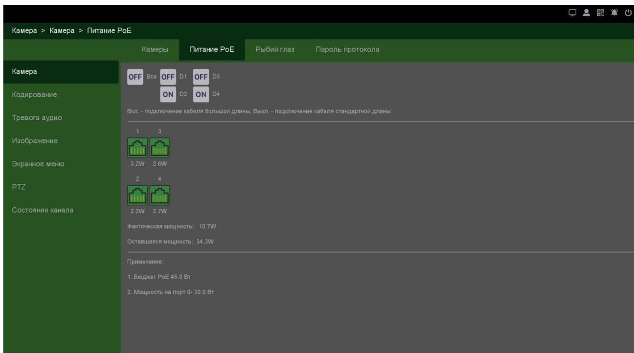
В верхней части экрана находятся иконки портов коммутатора и регистратора, каждый порт можно переключить либо в стандартный режим работы 100 Мбит/с с длиной кабеля до 100 метров (режим **OFF**), либо в режим работы повышенной дальности (до 250м) со скоростью 10 Мбит/с (режим **ON**).
